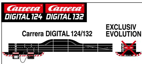
请注意, Exclusiv/Evolution (模拟系统) 及 Carrera DIGITAL 124/132 (数码系统) 是两个完全不同的独立系统。我们在此强调, 组装轨道时应分别对待两个系统, 即 Exclusiv/Evolution 的连接轨道不得与 Carrera DIGITAL 124/132 的连接轨道, 包括其黑箱子, 安装于同一车道上。即使其中一系统的连接轨道接在电源上也不可以。此外, 所有 Carrera DIGITAL 124/132型的其它部件 (预选转辙器, 电子计圈器, 制动等) 都不得被安装在 Exclusiv/Evolution型轨道上, 即不可安装在模拟系统中。如不遵守以上提示, 则可导致 Carrera DIGITAL 124/132 部件损坏。此情况下, 质量担保失效。
