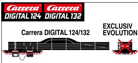
カレラのExclusiv/Evolution（アナログ式の）とDIGITAL 124/132（デジタル式）は、各構成が全く異なる独立したシステムです。コースを組み立てる場合、両システムを混ぜることがないようにしてください。また、Exclusiv/Evolutionの接続セクションとDIGITAL 124/132のブラックボックスつき接続セクションを同じコースで、ご使用になれます。さらに、Exclusiv/Evolutionの接続セクションまたはDIGITAL 124/132のブラックボックスつき接続セクションのどちらか一方の接続セクションのみを電源に接続する場合も、両システムを混ぜてお使いになれますので、ご注意ください。
